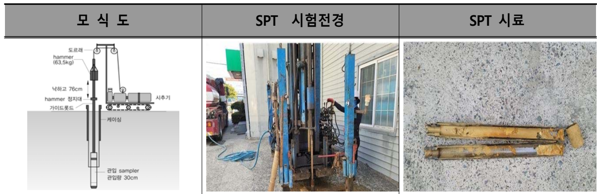
<그림 2.2> 표준관입시험 모식도 및 시험전경
